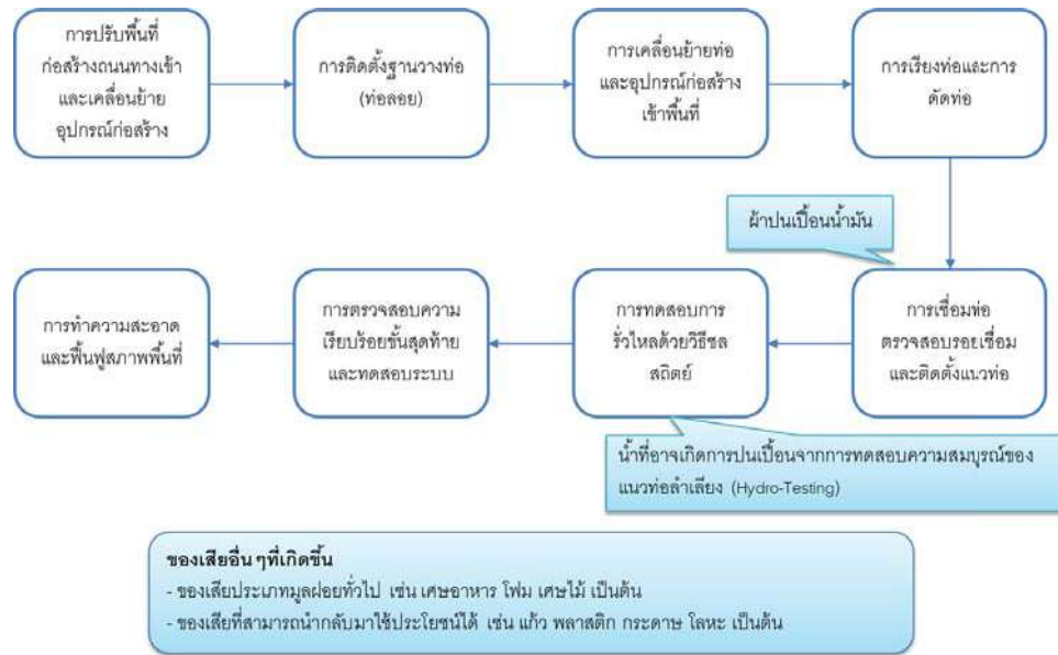
รูปที่ 2-22 แผนผังกระบวนการและแหล่งที่มาของของเสียในระยะก่อสร้างและติดตั้งแนวท่อลำเลียง
