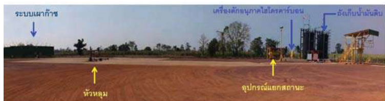
รูปที่ 2-4 แผนผังกระบวนการทดสอบหลุม และตัวอย่างการวางองค์ประกอบในฐานหลุมผลิต
